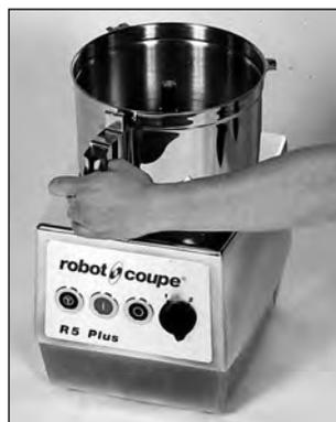
3) Наденьте нож на ось двигателя, и протолкните его на дно емкости.
