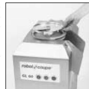
3) Зафиксируйте мешалку на валу двигателя
