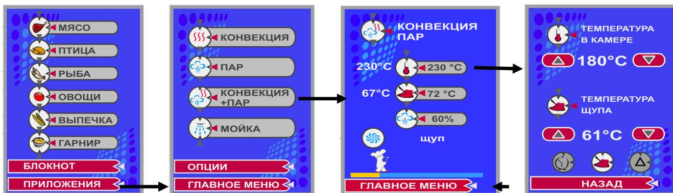
Рисунок 10. Переходы экрана для незапрограммированного режима работы пароконвектомата.
