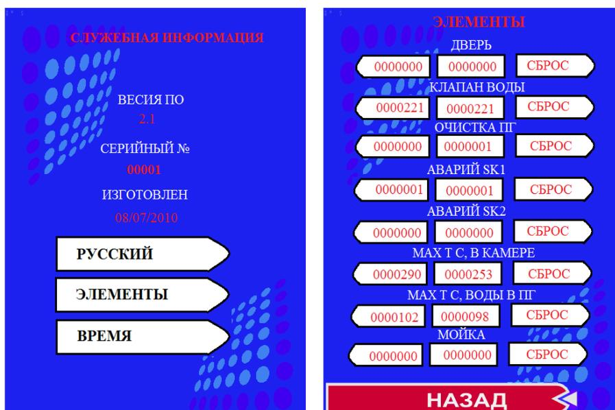
Значение в среднем столбце экрана отображает общее время наработки с момента записи программы в память контроллера или после сервисного обслуживания. Значение возможно обнулить. Третий столбец (правый) кнопки сброса параметра. Сброс параметра осуществляется при удерживании кнопки более 3с.
