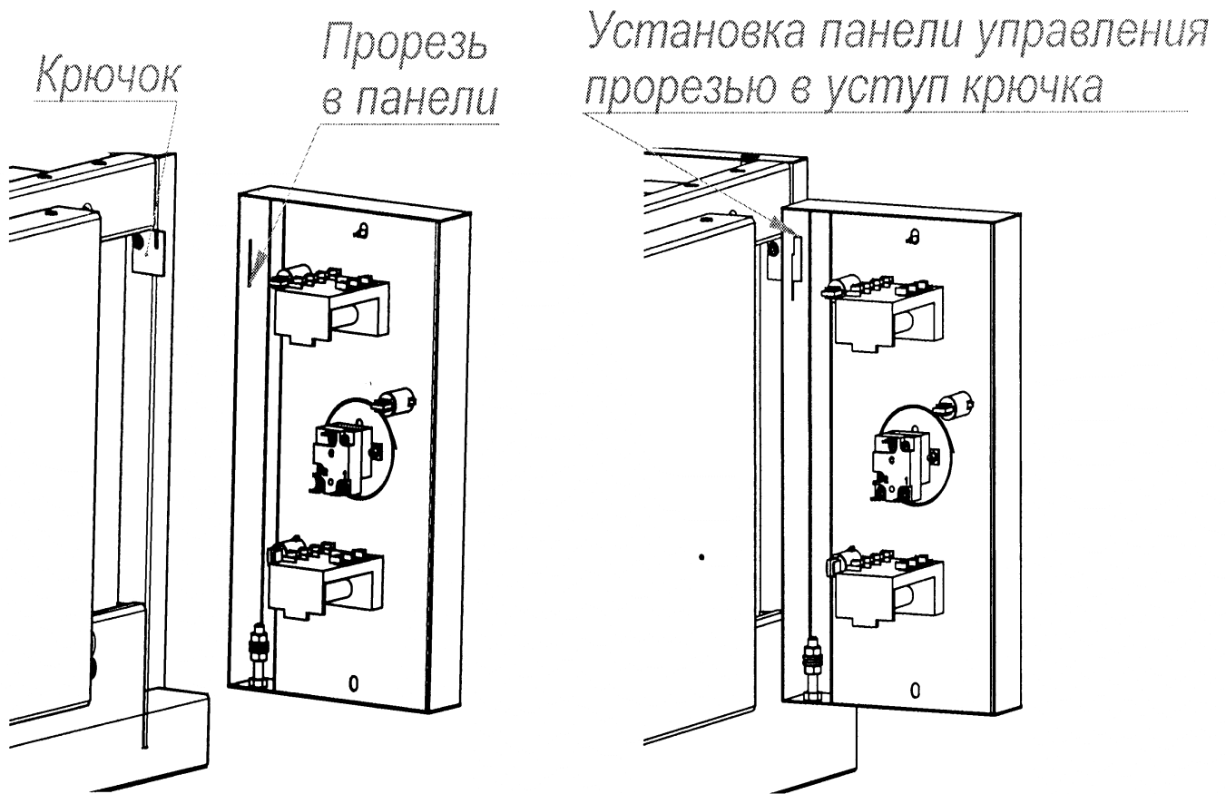
Рис. 5. Технологическое окно для замены контрпетли.
