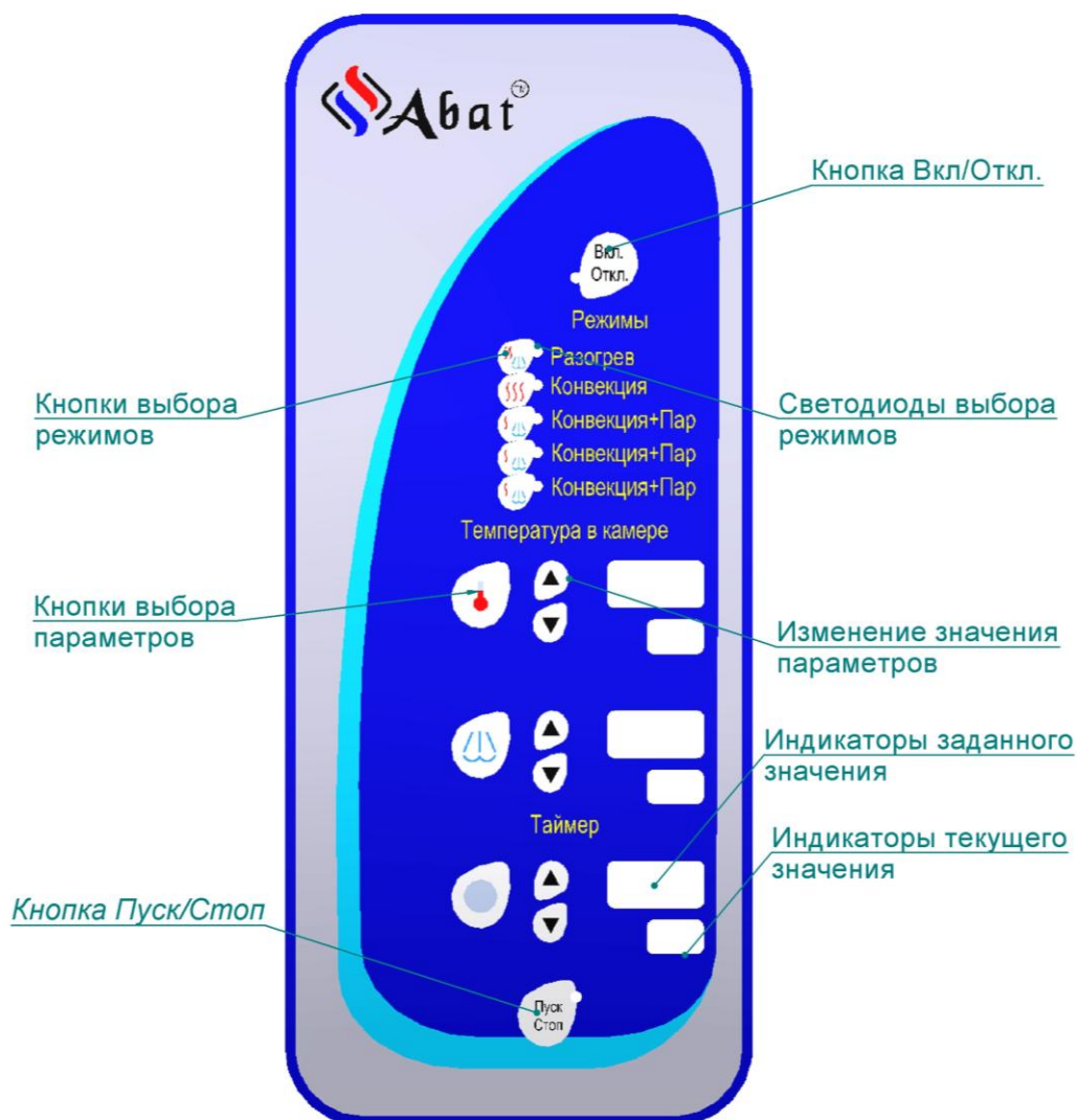
Рис. 3. Панель управления ПКА
