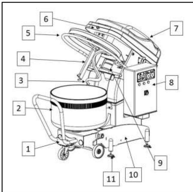
1) ТЕЛЕЖКА: средство для опоры и перемещения ванны, состоящее из рамы, установленной на колеса.
