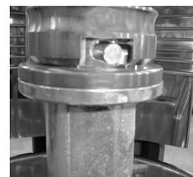
Для того, чтобы вытащить смесь, надо дождаться остановки рабочего органа. Затем надо повернуть защитную решетку, опустить дежу с помощью панелью управления и освободить рабочий орган из закрепляющего устройства.
