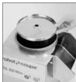
Установите затем соответствующий диск-измельчитель (диск с прямым лезвием) и прокрутите его в направлении часовой стрелки, чтобы проверить правильность его установки.
