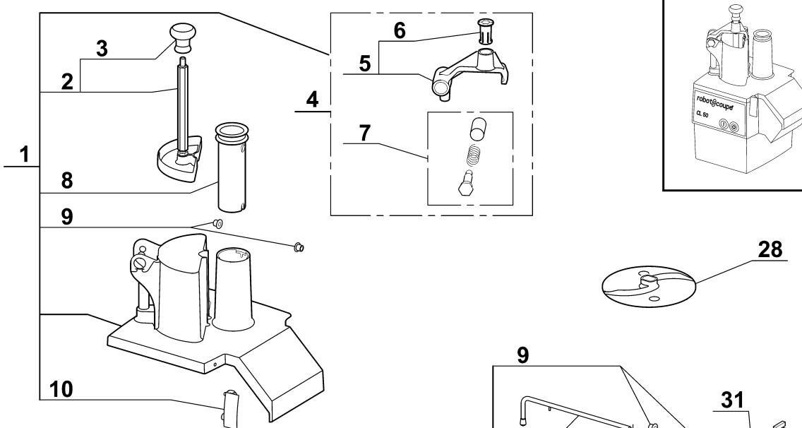
**ATTENTION :** Il existe 2 configurations au niveau de l'arbre de transmission et des joints d'étanchéité associés. Choisir parmi les repères 11 à 13 ou 15 à 18, selon la hauteur des **plats d'entrainement** de l'arbre de transmission sur votre machine.
