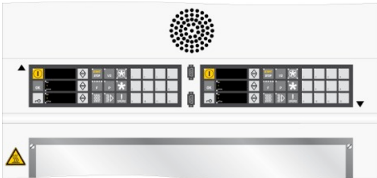
Рис. 2 Система управления с программированием для двухконтурного исполнения MIWE econo 8.0604
