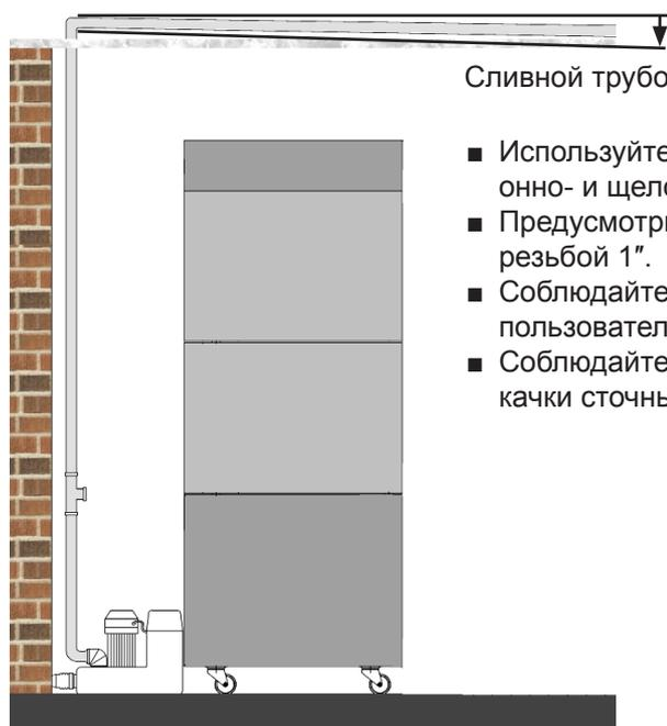
Сливной трубопровод с уклоном мин. 1°
